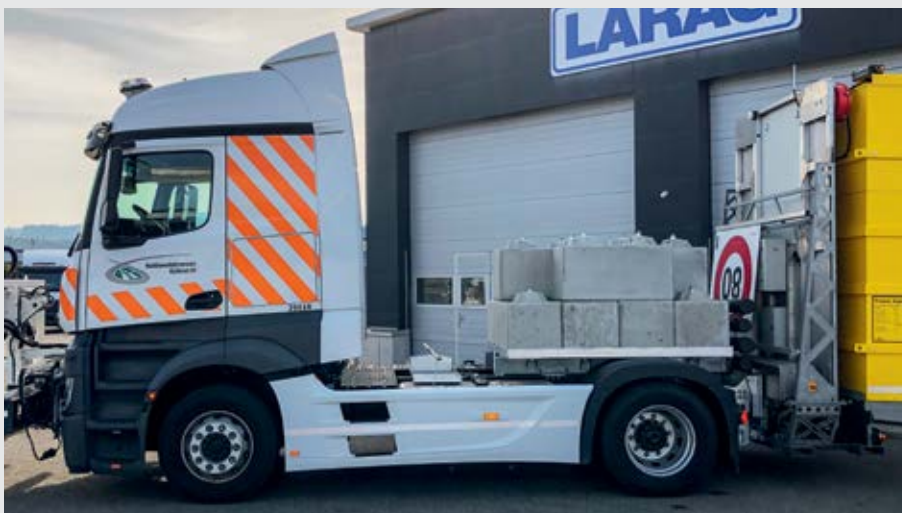
SwissBlock®-TEC kraftschlüssig mit Fahrgestell verschraubt
